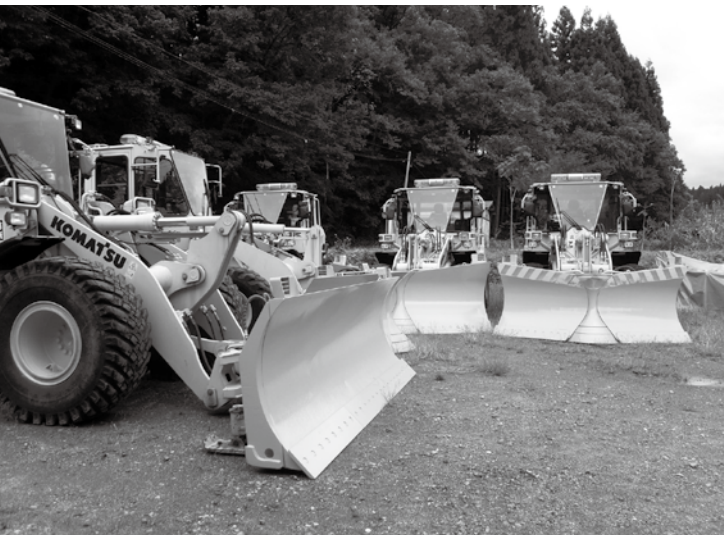
道路除雪用の除雪ドーザー 町民の足の確保に努めています
